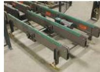
Banda transportadora con transferencia de cadena
